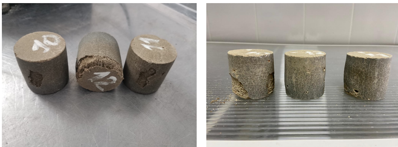
Рис. 1. Вид образцов после испытаний на прочность при сжатии: слева образцы без модификатора MADOR после 26-го цикла Мрз, справа образцы с модификатором MADOR после 48-го цикла Мрз
