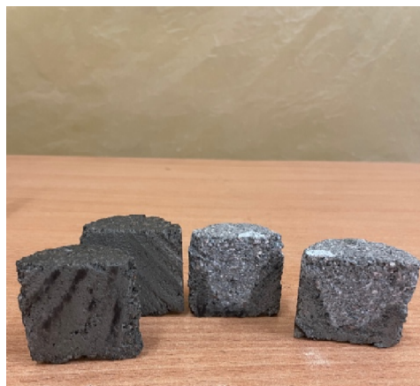
Рис. 3. Вид образцов после 3 сут в воде. Образцы слева укреплены цементом, образцы справа укреплены цементом и модификатором MADOR
