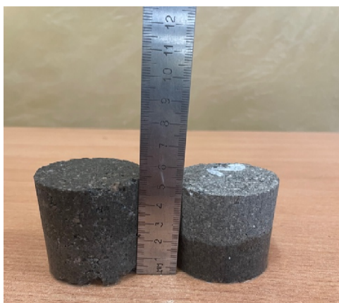
Рис. 3. Вид образцов после 3 сут в воде. Образцы слева укреплены цементом, образцы справа укреплены цементом и модификатором MADOR
