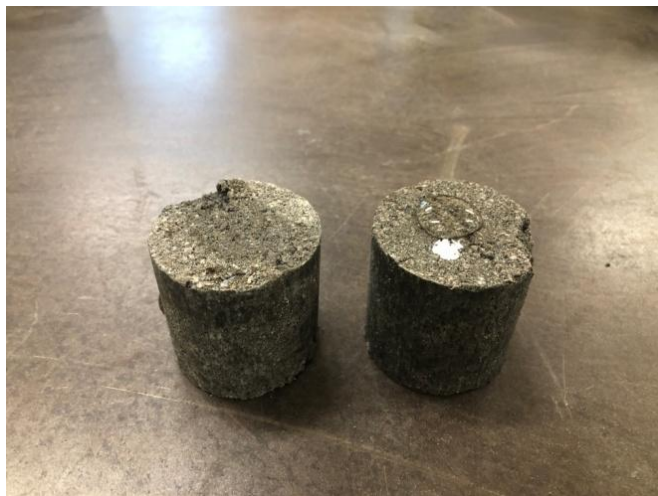
Рис. Вид образцов после попадания воды. Слева образец без модификатора, справа образец с модификатором MADOR
