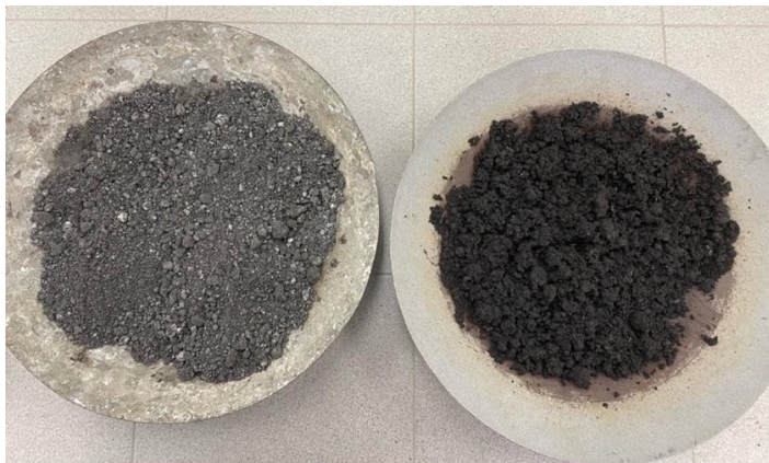
Рис. 1. Слева — вид гумусированного грунта, обработанного 5 % извести, справа — вид гумусированного грунта, не обработанного известью
